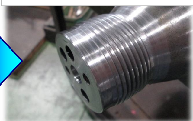
肉盛溶接部のねじ山再生及び浸食対策加工後
