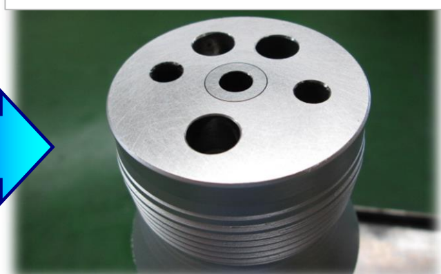
ノズルメタルタッチ部のBUSH圧入・タッチ面仕上げ
