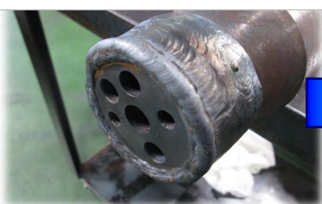
ノズルナット取付ねじ部の肉盛溶接後(下処理)
